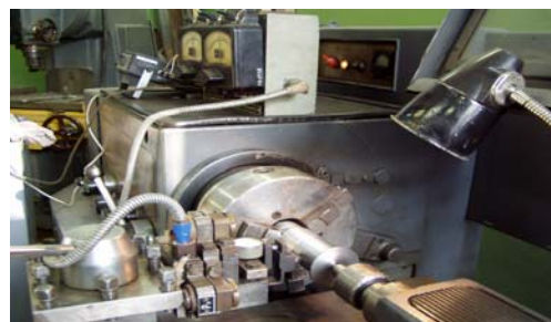
Рис. 2. Фотография экспериментальной установки для исследования деталей на износ
